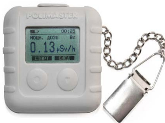
Рис 1. Общий вид дозиметра индивидуального рентгеновского и гамма-излучения ДКГ-PM1610.
