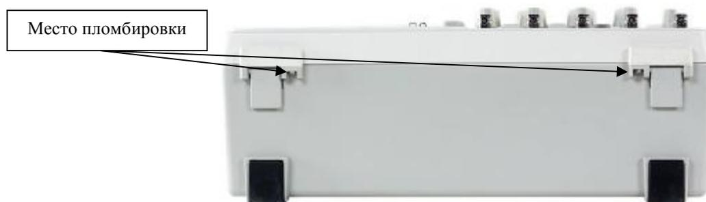
Рисунок 7 - Схема пломбировки осциллографов
