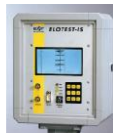
Рисунок 1 – Общий вид Дефектоскопов вихретоковых ELOTES T IS ELOTES T IS/MC
