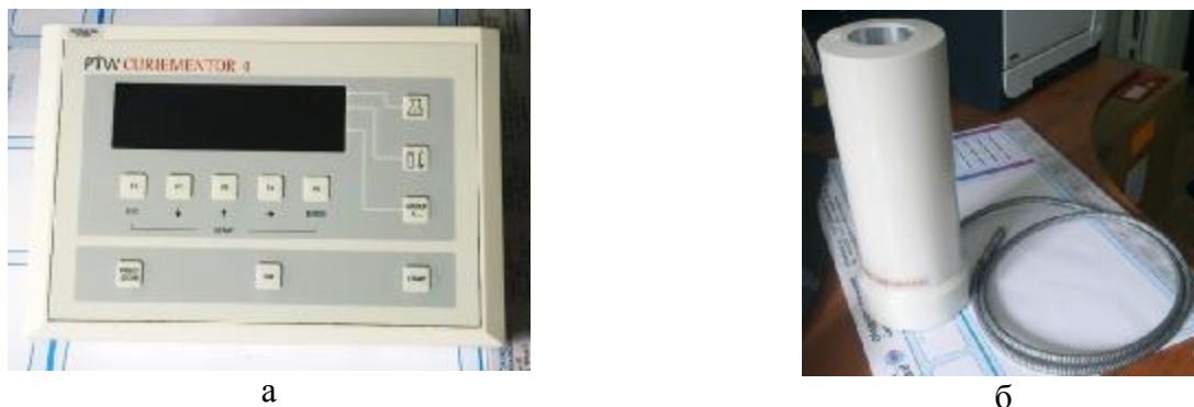
Рис. 1 Общий вид дисплейного блока (а) и ионизационной камеры (б) радиометра
