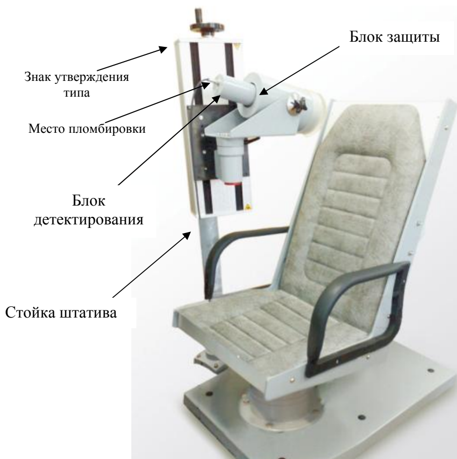
Рисунок 1. Внешний вид гамма-спектрометра СКГ-АТ1322 «Йодный СИЧ», места пломбировки и размещения знака утверждения типа.
