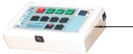
Рисунок 2 - Место для пломбирования узла управления, сбора и обработки данных комплекса
