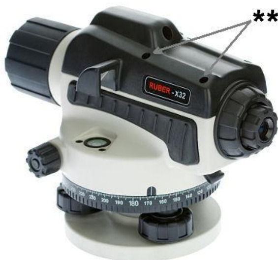
Рисунок 8 - Схема пломбировки от несанкционированного доступа нивелира ADA Ruber-X32 Примечание ** - места пломбирования от несанкционированного доступа
