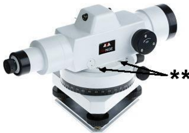
Рисунок 10 - Схема пломбировки от несанкционированного доступа нивелира ADA Range Примечание ** - места пломбирования от несанкционированного доступа
