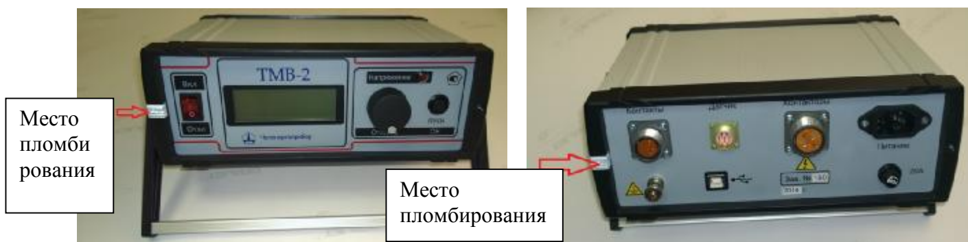
Рисунок 2 – Вид пломбировки прибора ТМВ-2 от несанкционированного доступа на задней панели.
