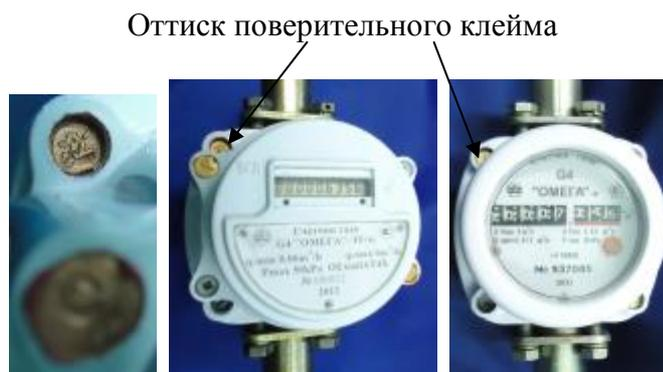
Рисунок 2 – Схема опломбирования счетчика, обозначение мест нанесения знака поверки
