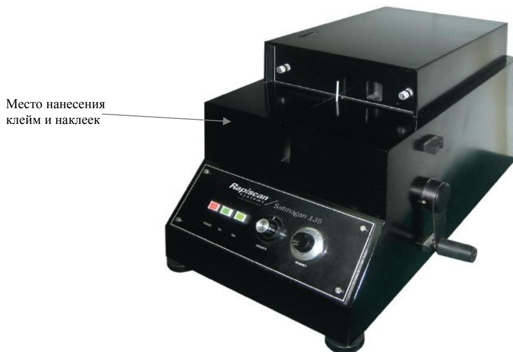
Рисунок 1 – Фото общего вида анализатора Satmagan 135
