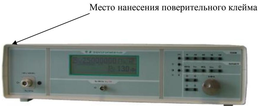
Рисунок 1. Общий вид генератора и место нанесения поверительного клейма
