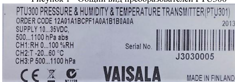
Рисунок 2 – Общий вид маркировки на корпусе преобразователей PTU300
