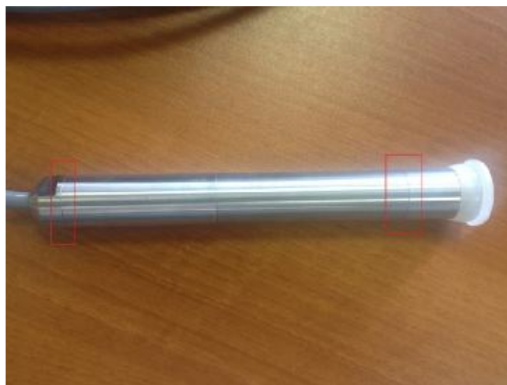
Рис.3 Уровнемер поплавковый Surfloat Sensor II с указанием мест пломбирования
