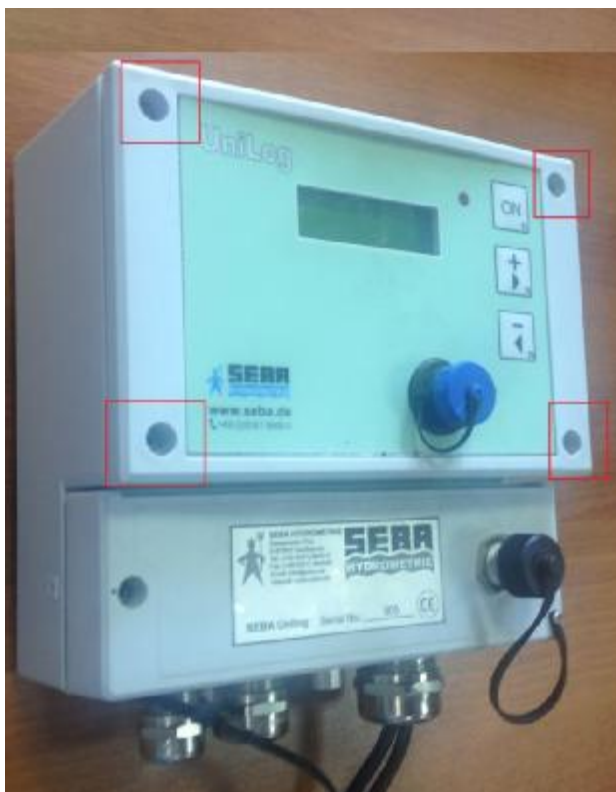
Рис.2 Контроллер SEBA MDS-5-Unilog с указанием мест пломбирования
