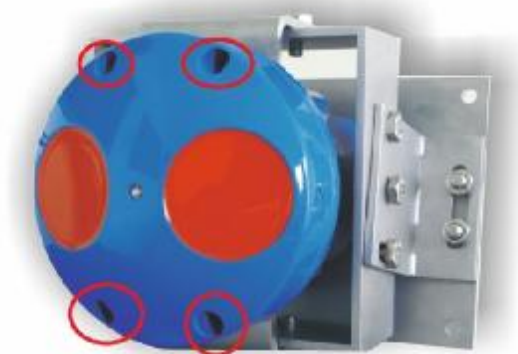
Рис.7 Горизонтальный акустический доплеровский профилограф течений Channel Master 600 (H-ADCP Q-EYE-H-ADCP) с указанием мест пломбирования
