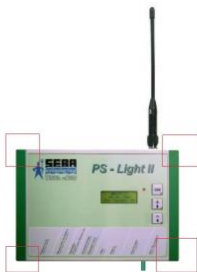
Рис.5 Уровнемер барботажный PS-Light-II с указанием мест пломбирования
