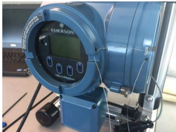
Рисунок 8. Вариант пломбирования корпуса электронного преобразователя модели 5700.
