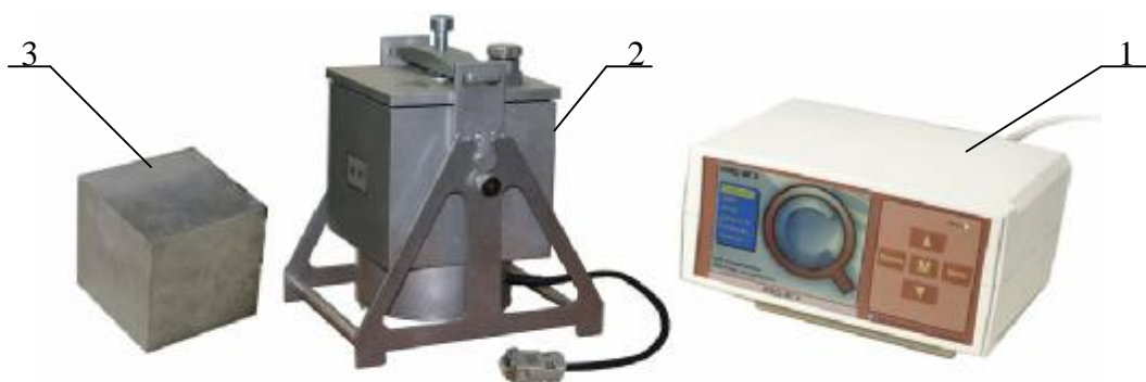
1 – блок управления 2 – измерительная камера 3 – опорный образец
