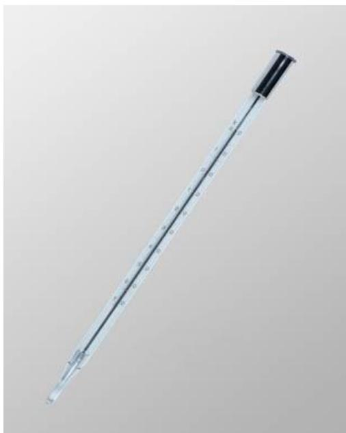
Принцип действия термометра основан на тепловом изменении объема термометрической жидкости, в зависимости от температуры измеряемой среды.
