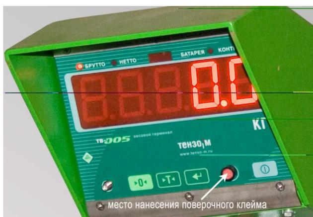
Рисунок 2 - Место нанесения поверочного клейма
