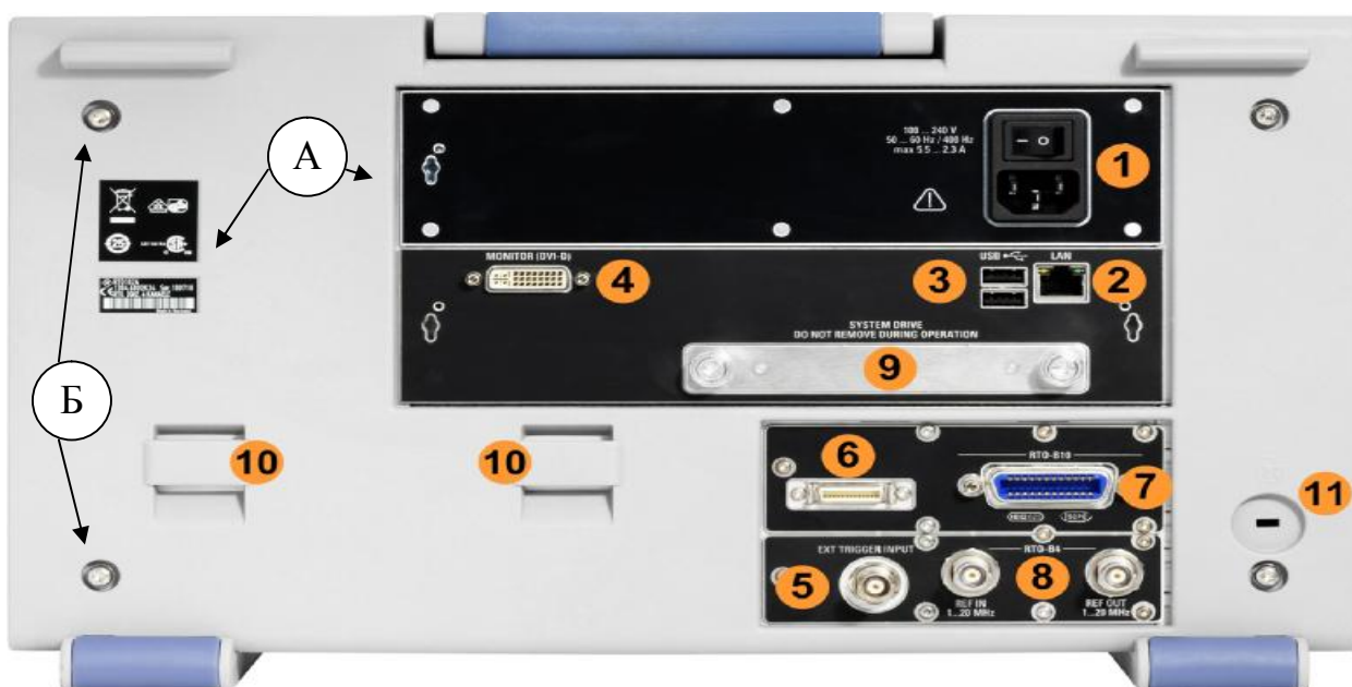
Рисунок 2 - а) Места для размещения наклеек б) Места для пломбировки от несанкционированного доступа
