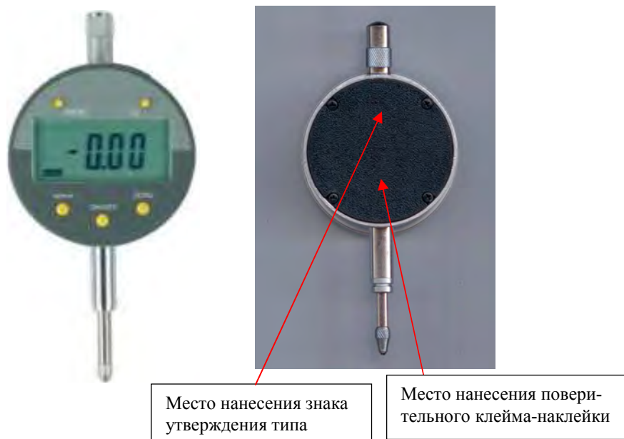
Рис. 1 Общий вид головки измерительной цифровой и место нанесения поверительного клейма-наклейки и знака утверждения типа
