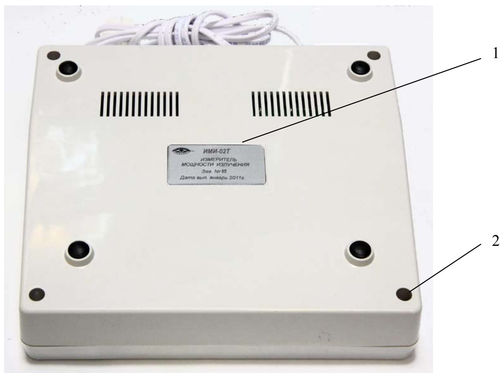
Рисунок 2 - Схема пломбирования и маркировки измерителя мощности излучения ИМИ-02Т 1 - место нанесения маркировки, 2 – место установки пломбы.
