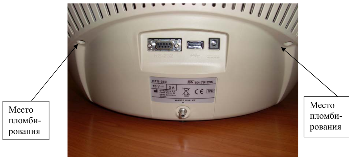
Рисунок 2 - Места пломбирования анализатора биохимического полуавтоматического BTS-350
