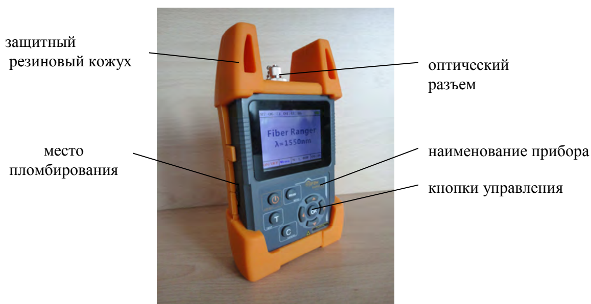
Рисунок 1- Схема маркировки передней панели прибора
