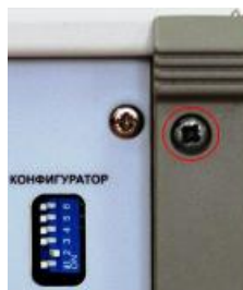
Рисунок 2 – Место на задней панели для пломбирования (отмечено красным)
