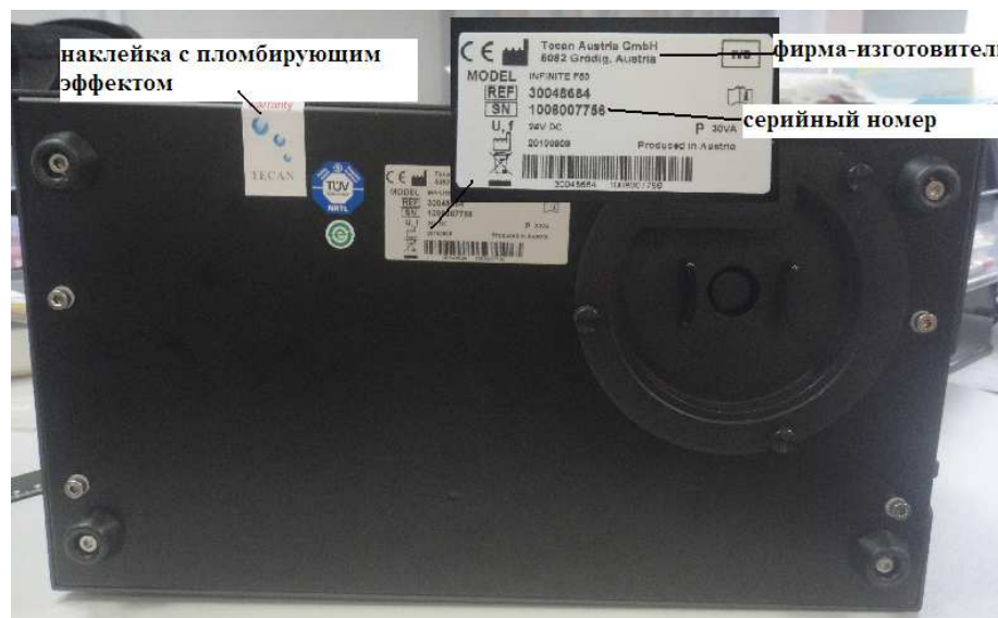
Рисунок 2 – Схема маркировки и пломбировки (нижняя панель)
