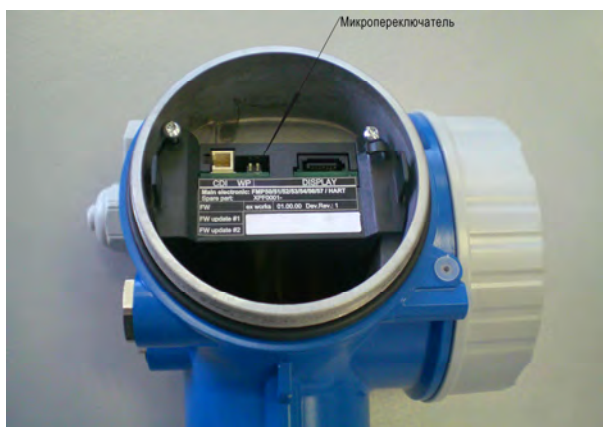
Рисунок 2. Микропереключатель для защиты от несанкционированного доступа к настройкам
