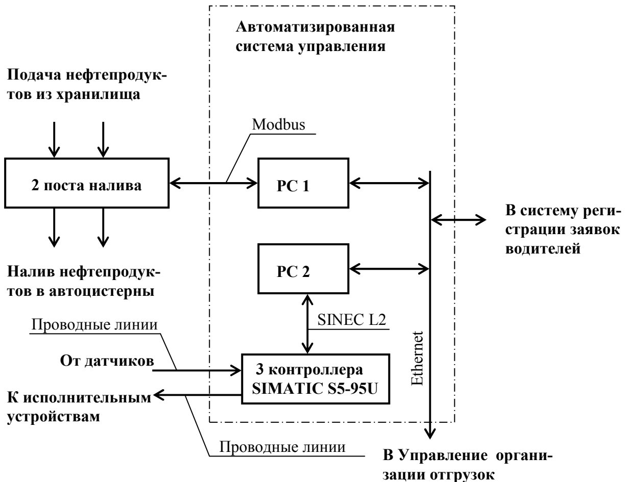
Рис.1 Упрощенная структурная схема комплекса измерений массы светлых нефтепродуктов КИМ-90-2.
