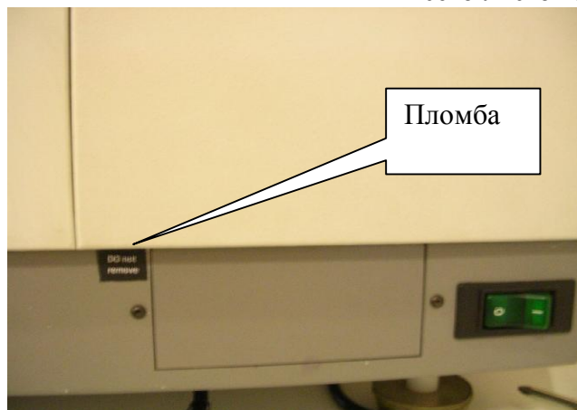
Рисунок 4 - Анализатор - коагулометр Destiny Max. Расположение пломбы.
