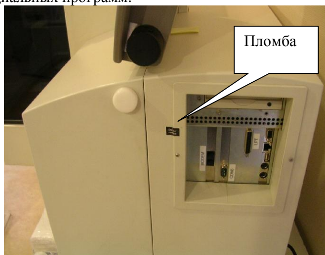
Рисунок 2 - Анализатор - коагулометр Destiny Plus. Расположение пломбы.
