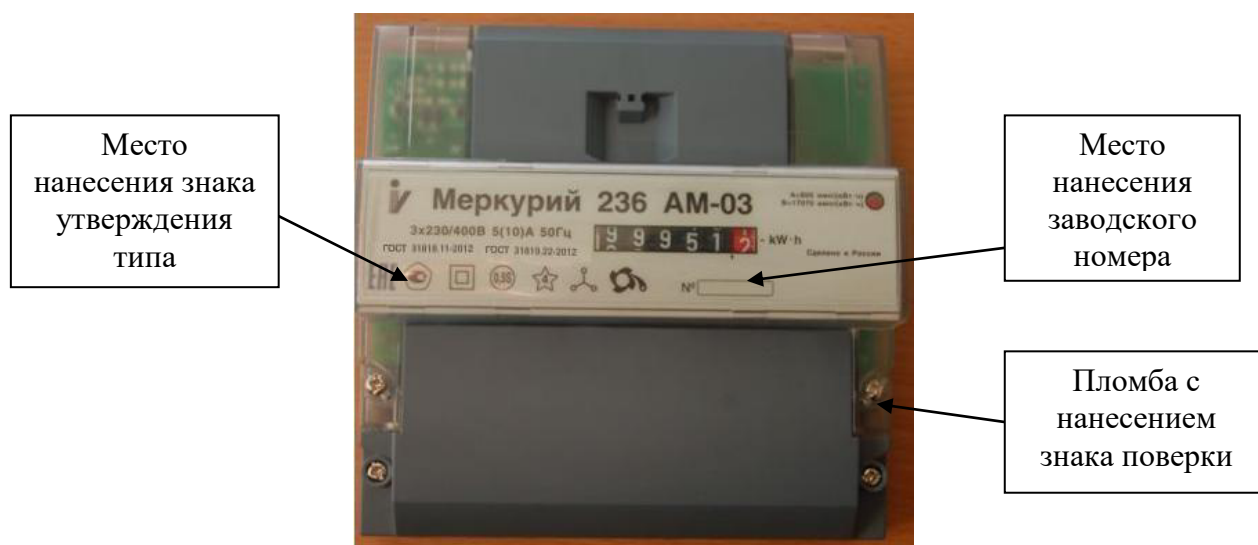
Рисунок 1 – Общий вид счетчиков «Меркурий 236АМ-0Х» с указанием места ограничения доступа к местам настройки (регулировки), места нанесения знака утверждения типа, места нанесения заводского номера
