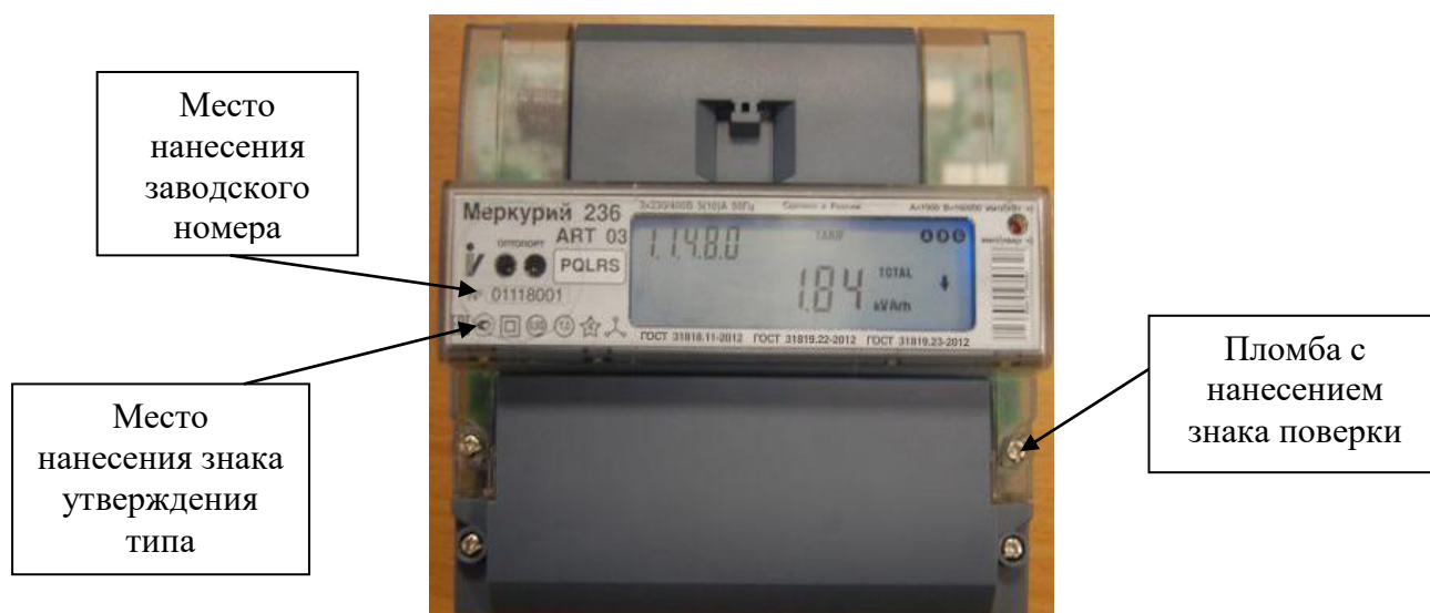
Рисунок 2 – Общий вид счетчиков «Меркурий 236А(Р)(Т)...» с указанием места ограничения доступа к местам настройки (регулировки), места нанесения знака утверждения типа, места нанесения заводского номера
