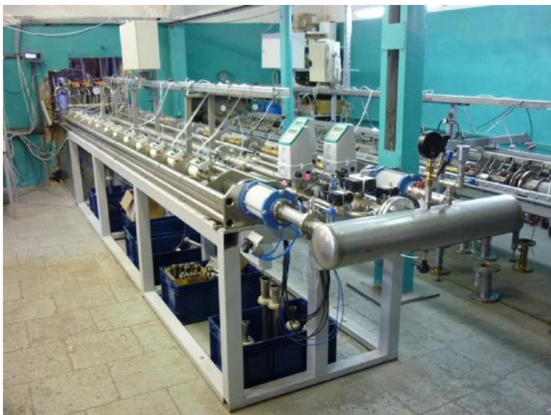
Рисунок 1 – Внешний вид установки поверочной расходомерной
