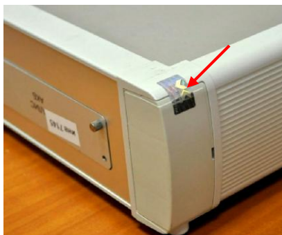
Рисунок 2а - Место для пломбировки от несанкционированного доступа
