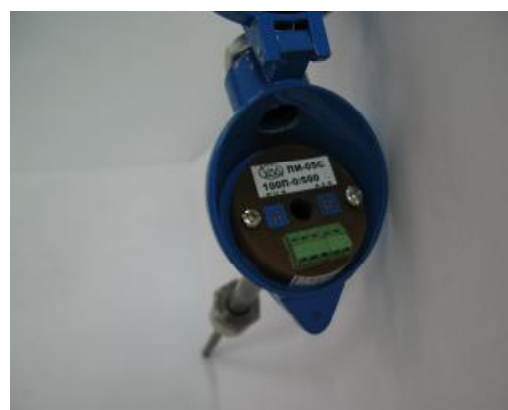
Рисунок 1 - Термопреобразователи с унифицированным выходным сигналом УТП, УТС общепромышленного назначения
