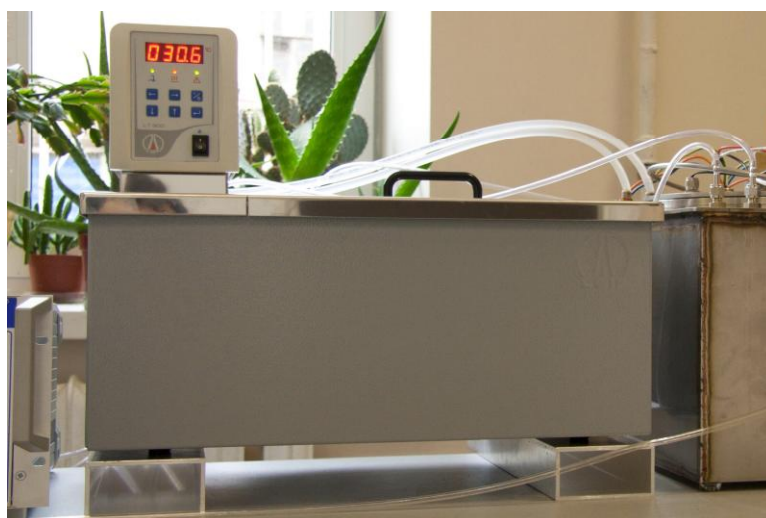
Рис 2. Термостат LOIP LT-324
