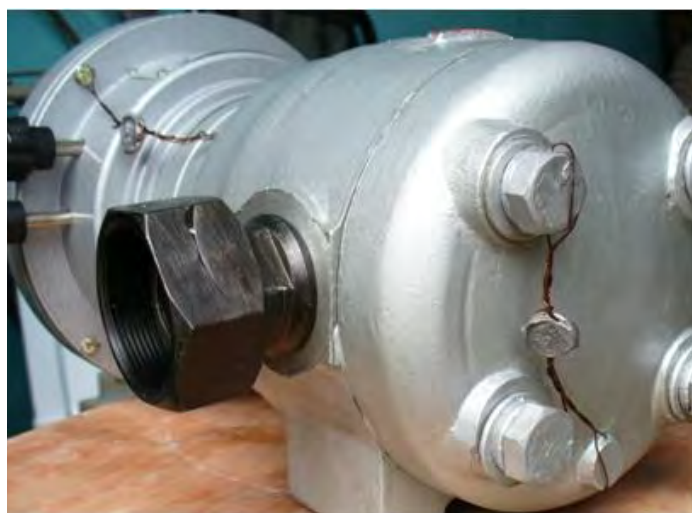
Фото 2 - Схема пломбировки счетчика от несанкционированного доступа
