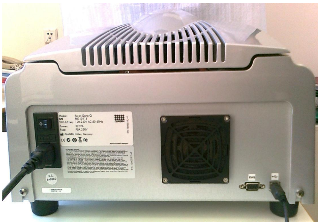
Рисунок 2. Внешний вид прибора для проведения полимеразной цепной реакции в режиме реального времени Rotor-Gene Q. Вид сзади
