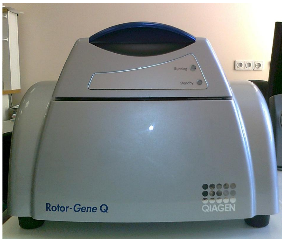
Рисунок 1. Внешний вид прибора для проведения полимеразной цепной реакции в режиме реального времени Rotor-Gene Q
