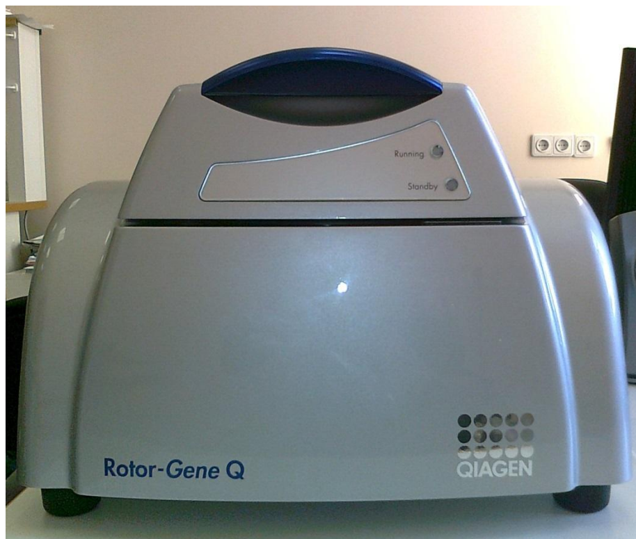
Рисунок 1 - Общий вид прибора для проведения полимеразной цепной реакции в режиме реального времени Rotor-Gene Q
