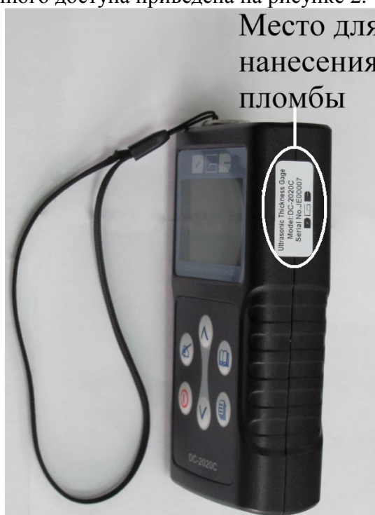
Рисунок 2 - Схема пломбировки от несанкционированного доступа
