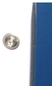
Рисунок 2 - Изображение специальных защитных винтов на задней панели прибора.
