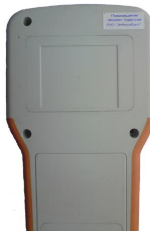
Рисунок 2 – Схема и внешний вид пломбировки калибратора от несанкционированного доступа.
