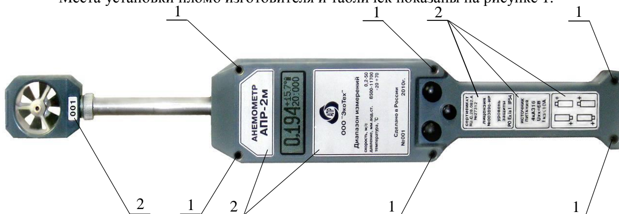
Рисунок 1 - Анемометр рудничный АПР-2м
