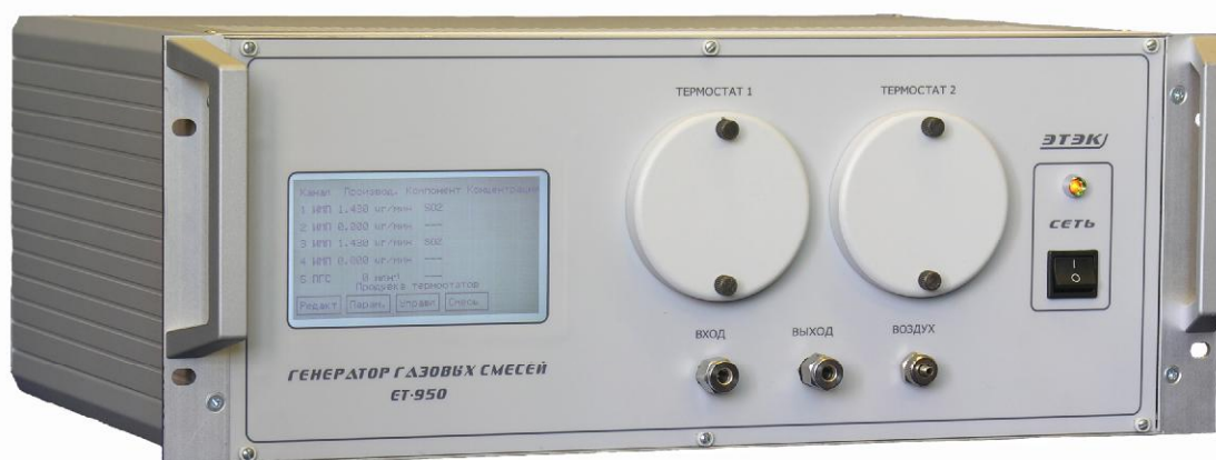
Рис.1. Внешний вид рабочих эталонов 1-го и 2-го разрядов - генераторов газовых смесей ET-950.
