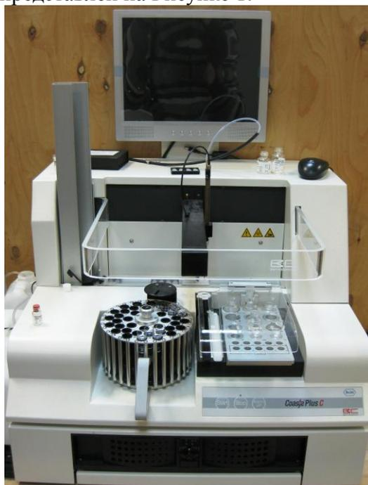
Рисунок 1 - Коагулометр автоматический Coasys Plus C
