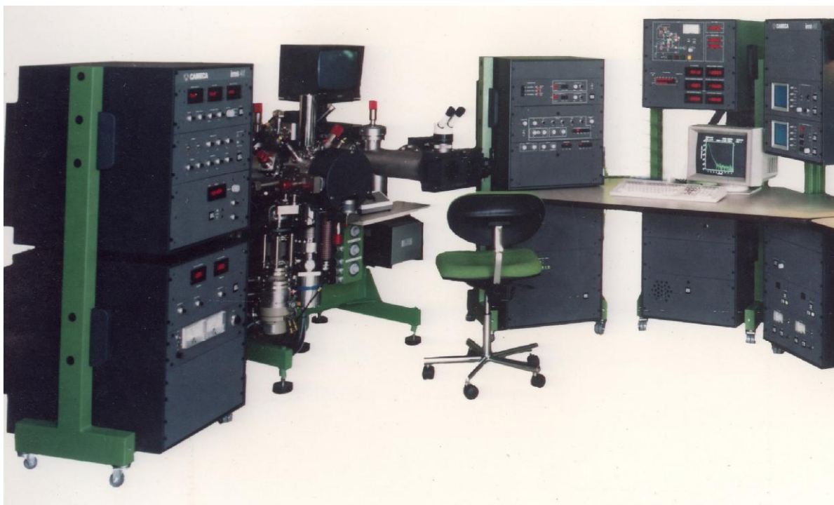
Рисунок 1. Общий вид масс-спектрометра вторично-ионного микрозондового IMS-4f с системой динамического переноса
