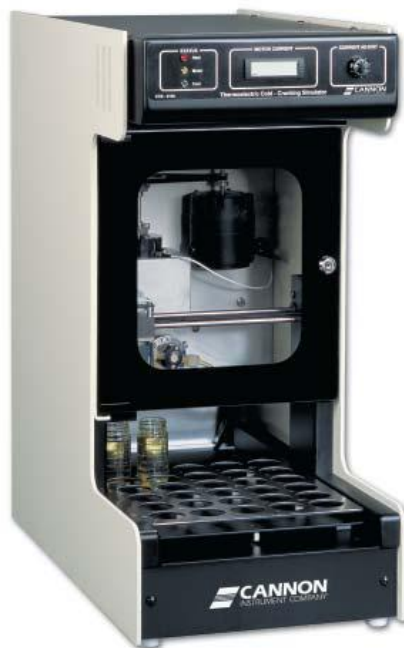
Рисунок 1 - Внешний вид имитатора CCS-2100
