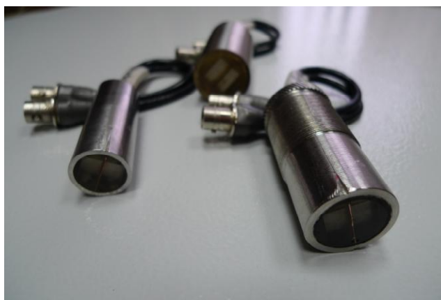
Рисунок 1 - Фотография общего вида ПЭП
