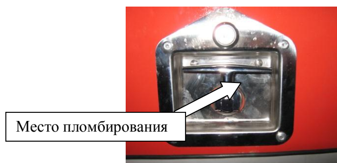
Рисунок 5 – Ручка открывания отсека для размещения узла выдачи топлива АТЗ
