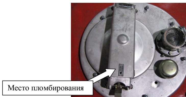
Рисунок 3 – Запорный механизм крышки заливной горловины АТЗ
