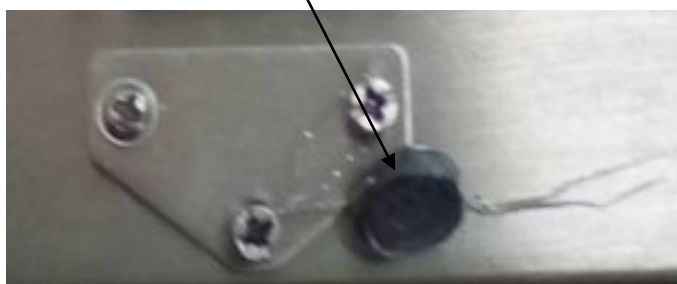
Рисунок 3 – Схема пломбировки от несанкционированного доступа и обозначение места для нанесения оттиска клейма индикатора СТТ-А
