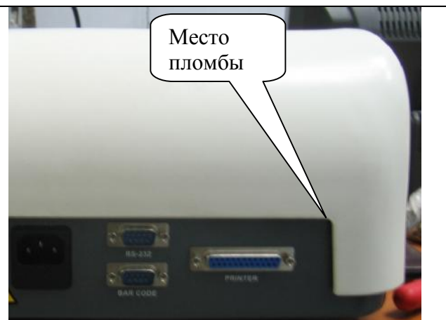
Рисунок 2 – Расположение пломбы. Анализатор мочи Н-100
