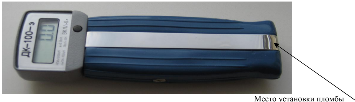
Рисунок 1 - Общий вид средства измерений и схема пломбировки от несанкционированного доступа
