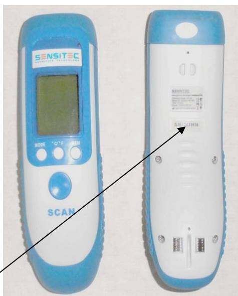
Место пломбировки от несанкционированного доступа Рисунок 5 - Модель SENSITEC NB-402
