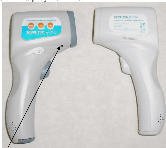
Место пломбировки от несанкционированного доступа Рисунок 2 - Модель SENSITEC NF-3102
