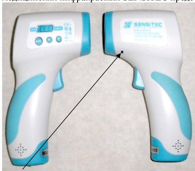
Место пломбировки от несанкционированного доступа Рисунок 1 - Модель SENSITEC NF-3101
