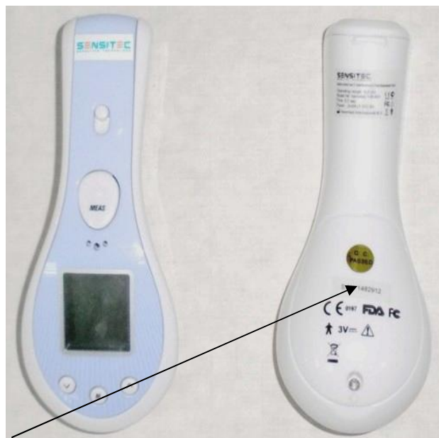
Место пломбировки от несанкционированного доступа Рисунок 4 - Модель SENSITEC NB-401
