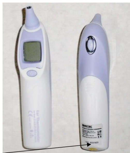
Место пломбировки от несанкционированного доступа Рисунок 6 - Модель SENSITEC ET-211
