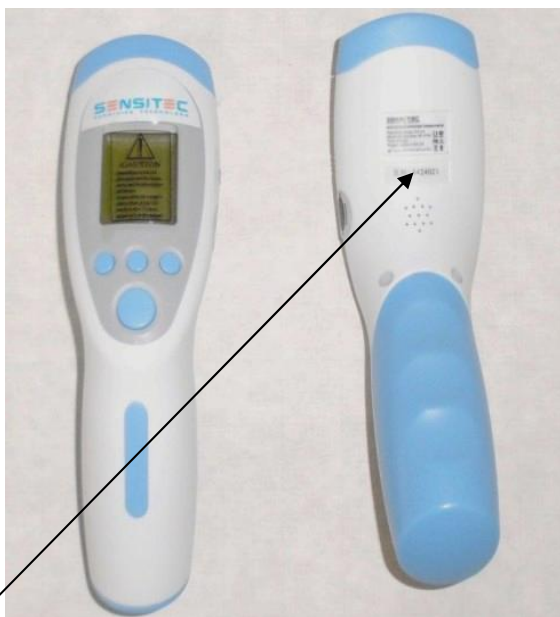
Место пломбировки от несанкционированного доступа Рисунок 3 - Модель SENSITEC NF-3103
