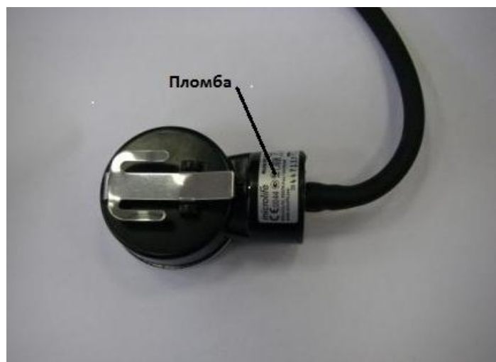
Рис.2 Фотография места пломбирования манометра средства измерений
